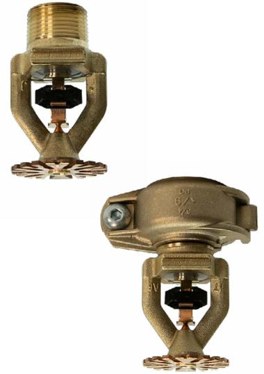
**\*Anmerkung:** Das Sprinklermodell JL17 besitzt eine FM-Zulassung sowie ein Prallblech des Modells S-3 für den Gebrauch als hängender Zwischendeckensprinkler. Der Durchmesser des Prallblechmodells S-3 beträgt 95 mm (3-3/4").
