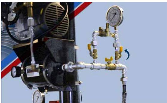
Die Ventile der Luft- bzw. Stickstoffversorgung der Anlage schließen.
