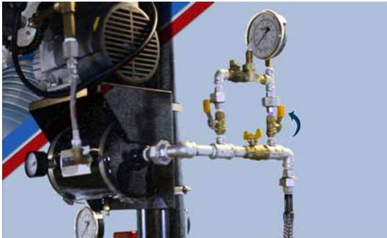
Fermer les vannes qui apportent de l'air ou de l'azote au système.
